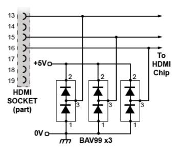
**Figure 2.3.11. Protection Diodes**
