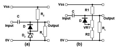
**Figure 2.3.10. Changing Clamping Levels**
