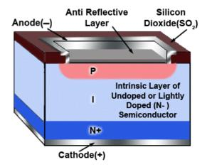
Fig. 2.7.8 PIN Photodiode
