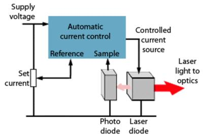
Fig. 2.6.6. Controlling the Laser Diode
