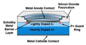
Figure 2.2.5. Schottky Rectifier Diode
