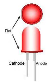
Figure 2.5.11. LED Polarity
