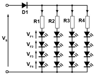
Figure 2.5.10. Series-Parallel LED Array
