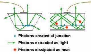
**Figure 2.5.7. Internal Reflection**
