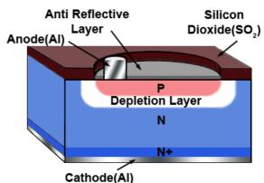
Fig. 2.7.3 Photodiode
