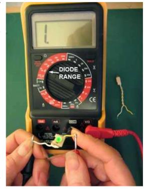
Figure 2.5.12. Testing a LED
