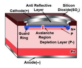
Fig. 2.7.8 The Avalanche Photodiode
